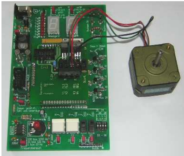
alte PLD-Platine mit bipolarem Schrittmotor
